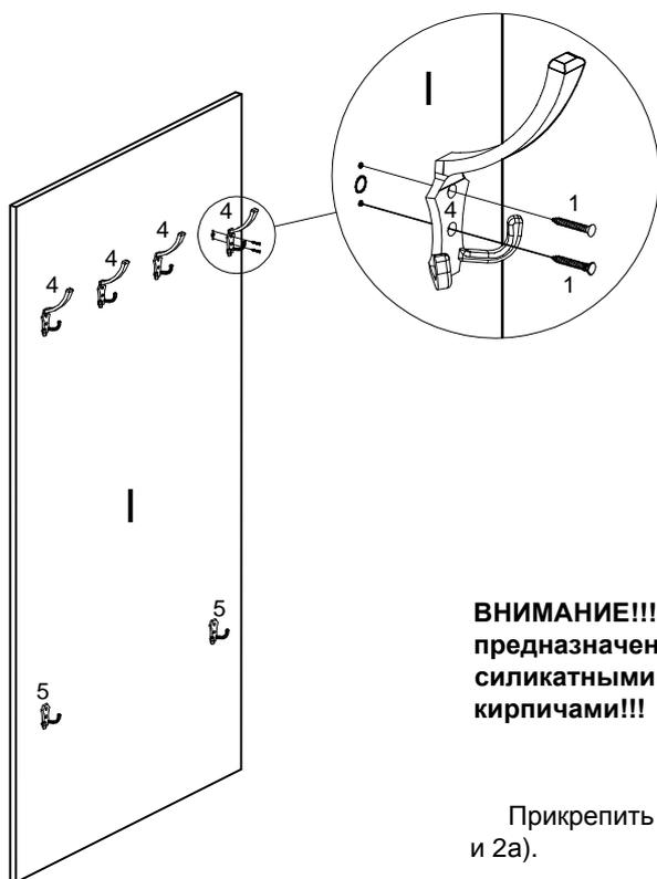
**ВНИМАНИЕ!!!** Следует учитывать, что система навески (2,3) предназначена для использования с полнотелыми кирпичами, силикатными полнотелыми кирпичами, бетоном или клинкерными кирпичами!!!
