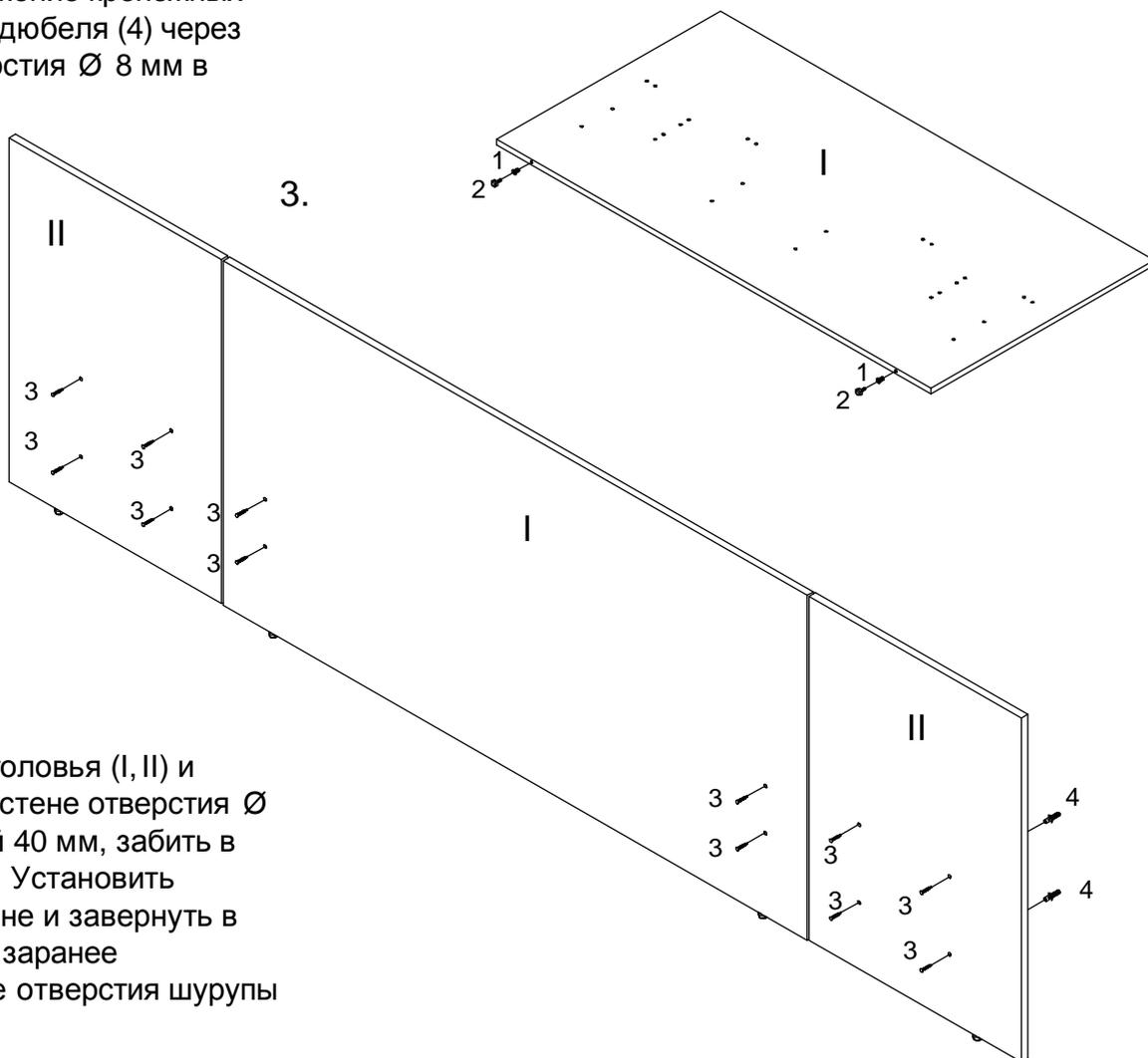
Отодвинуть изголовья (I, II) и просверлить в стене отверстия  $\varnothing 8$  мм и глубиной 40 мм, забить в них дюбеля (4). Установить изголовья к стене и завернуть в дюбеля сквозь заранее просверленные отверстия шурупы (3) (см. рис. 3).
